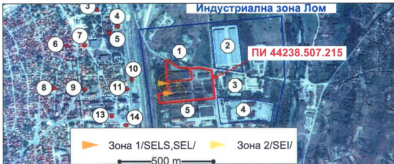
Фигура П.1.3-1 Зони на токсично въздействие при пожар на товарач в зоната на товаро-разтоварни дейности
