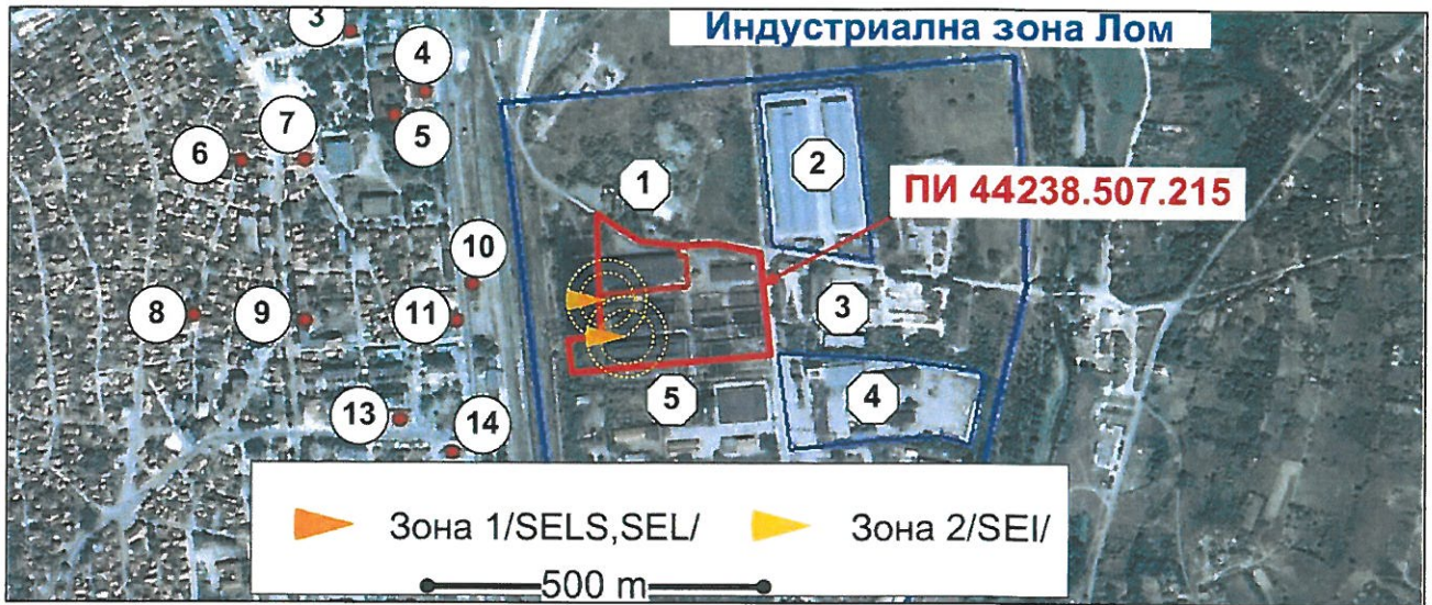
Фигура II.1.3-1 Зони на токсично въздействие при пожар на товарач в зоната на товаро-разтоварни дейности
