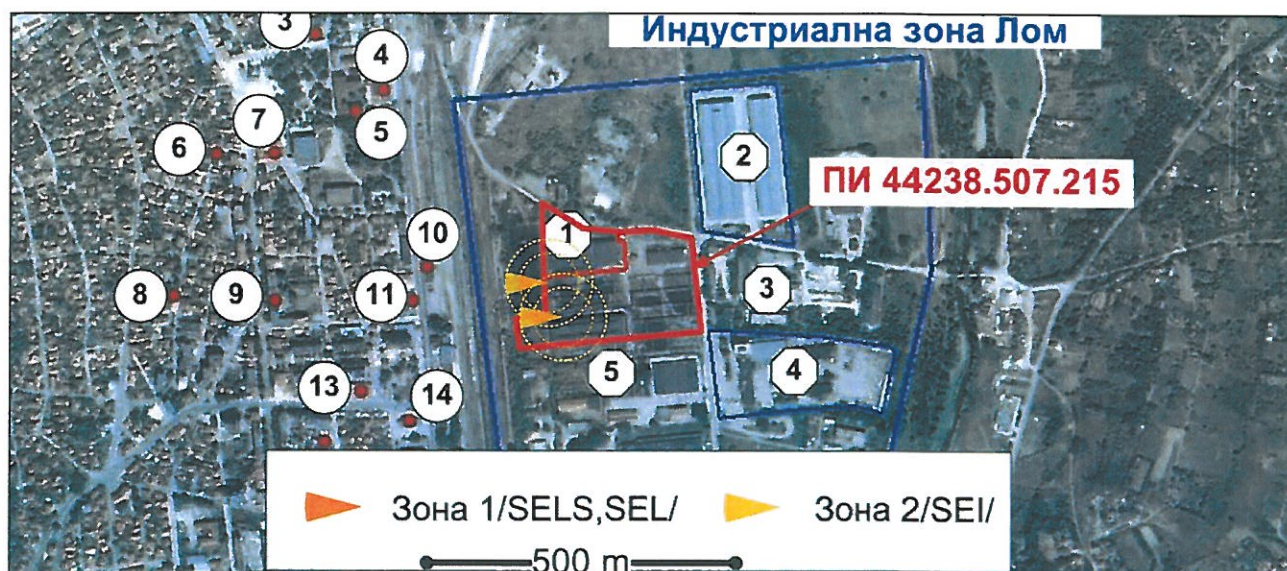
Фигура П.1.3-2 Зони на токсично въздействие при пожар на камион/ж.п. вагон в зоната на разтоварване
